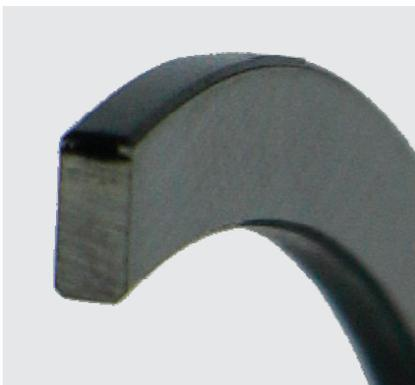
Fig. 1: Rivestimento DLC sulla superficie di scorrimento
