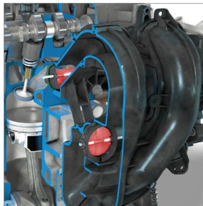
Válvulas en la tubería de aspiración
