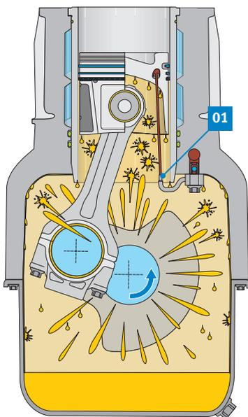
Рис. 2: Непосредственное и опосредованное смазывание деталей распылением и разбрызгиванием масла
