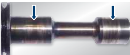
Abb. 3 Durch Ölmangel beschädigte Turboladerwelle
