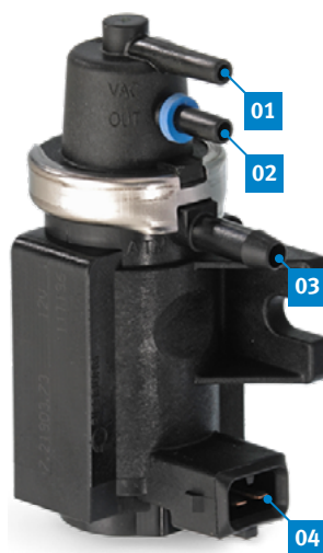
Рис. 2: Присоединительные элементы на клапане-преобразователе давления
