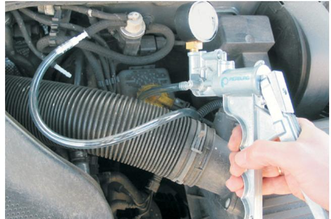
Comprobación de un convertidor electro-neumático de la presión con la bomba manual de vacío (VW Golf IV)(Pierburg número de artículo 12 00001 11 900)
