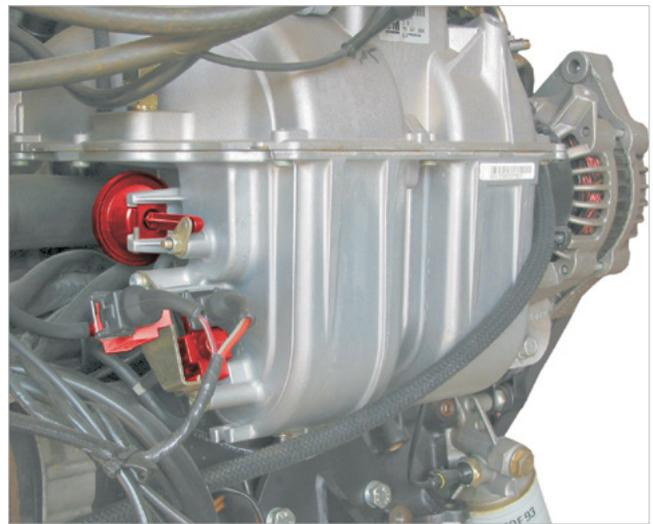
En el tubo de conmutaci n de la aspiraci n en el Opel Astra se encuentran instaladas dos v lvulas de inversi n (resaltadas en rojo). Una controla a trav s de la caja de presi n dispuesta sobre la misma (resaltada en rojo) la chapaleta del tubo de aspiraci n; la otra (no ilustrada) conmuta la v lvula de cierre del aire secundario.
