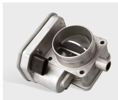
Dado que la diferencia de presión entre el lado de escape y de aspiración en los vehículos diésel no es suficiente para las elevadas tasas de recirculación de los gases de escape, en la tubería de aspiración se emplean "mariposas de regulación" para generar el vacío necesario.
