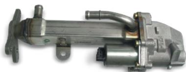
Fig. 1: Válvula EGR com radiador EGR
