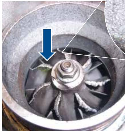
Abb. 1: Einschlagspuren des Fremdkörpers sind im Ansaugtrichter erkennbar
