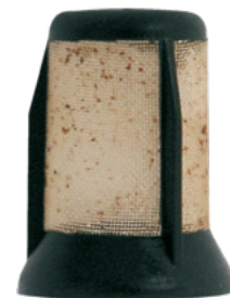
Prefiltro de la E3T obstruido por óxido
