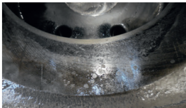
Uszkodzenia powierzchni wskutek mikrotarcia w skrzyni biegów
