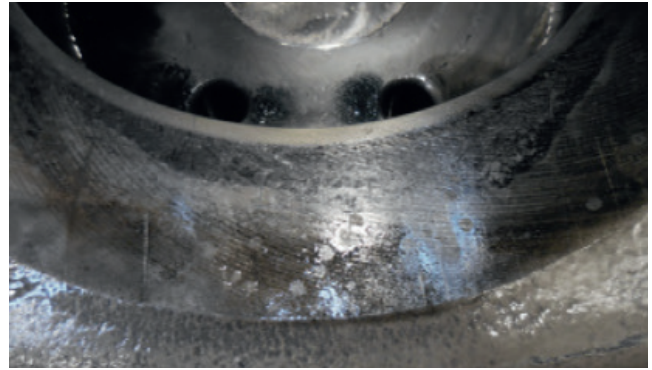
Bir şanzımda mikro sürtünme nedeniyle yüzey hasarları
