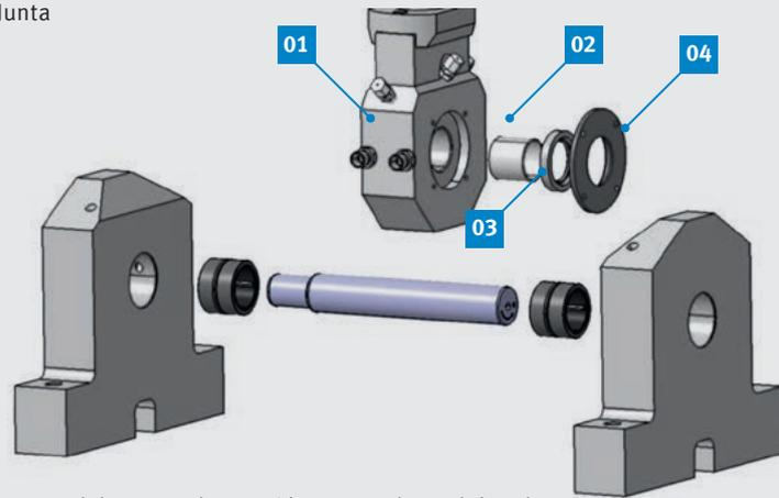
Estructura del ensayo de rotación en marcha en húmedo
