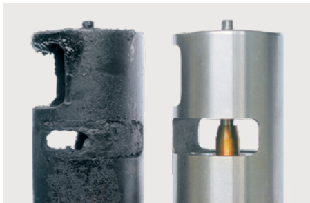
Válvula EGR pregada y nueva
