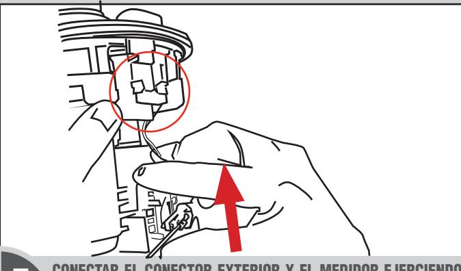
**5** CONECTAR EL CONECTOR EXTERIOR Y EL MEDIDOR EJERCiendo FUERZA HACIA ARRIBA.
