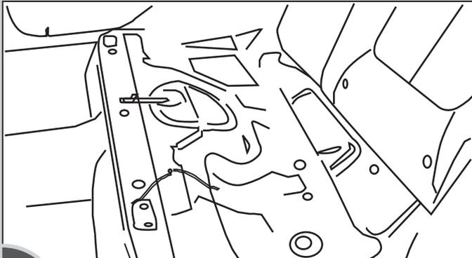
**1** EXTRAER CONJUNTO AFORADOR DEL DEPÓSITO DE COMBUSTIBLE LEVANTANDO LOS ASIENTOS, APARTANDO LA MOQUETA, QUITANDO LOS TUBOS, TORNILLOS Y/O TAPAS DE PLÁSTICO.
