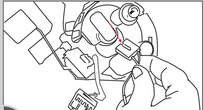
**4** DESCONECTAR EL CONECTOR DE LA BOMBA CON AYUDA DE UN DESTORNILLADOR.
