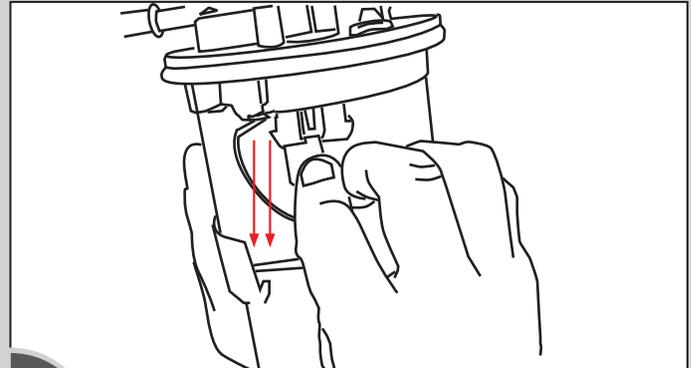
**2** DESCONECTAR MANUALMENTE EL CONECTOR DE LA PARTE SUPERIOR DEL FILTRO.
