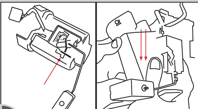
**5** RETIRAR EL MEDIDOR APLICANDO FUERZA PREVIAMENTE EN LA PESTAÑA CON LA AYUDA DE UN DESTORNILLADOR.
