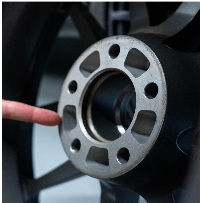
Bild 2: Gießtaschen in den verwendeten Rädern:
