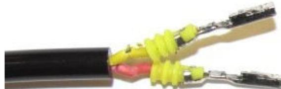
4. Steckersicherung öffnen. Fertig montierte und abgedichtetet Leitung vollständig in das Gehäuse einschieben und einrasten lassen. Pinposition / Kabelfarbe ist nicht relevant. Anschließend muss das Steckergehäuse verriegelt werden.
