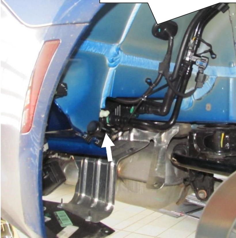
Leitung und Steckverbindung mit Kabelbindern befestigen.
