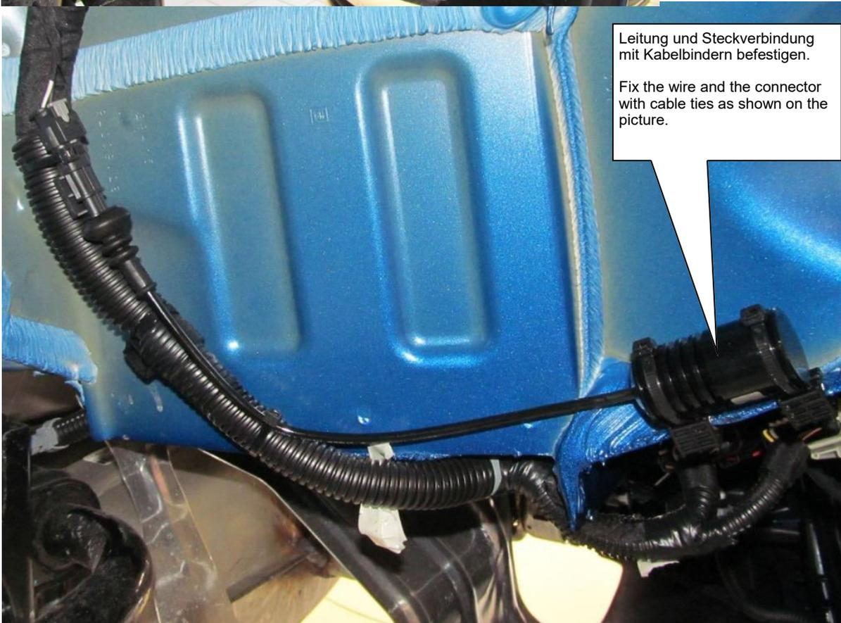
Leitung und Steckverbindung mit Kabelbindern befestigen.
