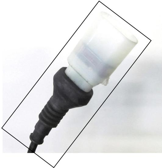
1. Die originale Dämpferleitung muss mit geeignetem Werkzeug aus dem Stecker ausgepinnt werden. **Achtung: Stecker nicht beschädigen!**
