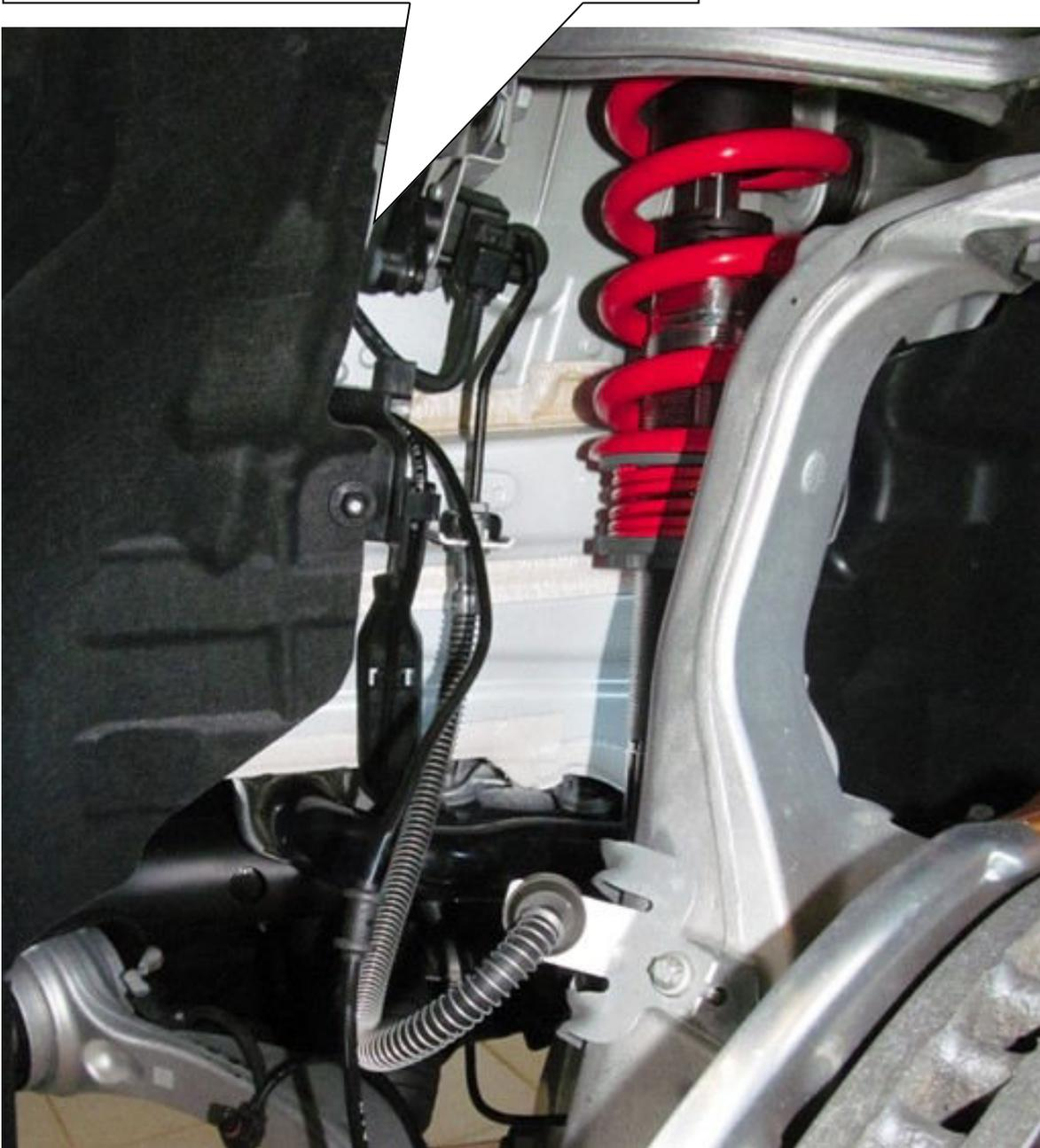
Die originale Dämpfersteuerungsleitung wird in die Stilllegung eingesteckt. Es muss auf die korrekte Verriegelung des Steckers geachtet werden! Anschließend wird die originale Dämpfersteuerungsleitung mittels der mitgelieferten Kabelbinde am Kabelbaum befestigt. Es ist darauf zu achten, dass die Leitung nirgends scheuert.
