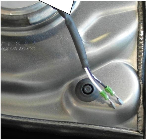
3. Originale Leitungen in den mitgelieferten Stecker ganz einschieben und einrasten. Pinposition / Kabelfarbe ist nicht relevant. Anschließend den Stecker verriegeln.
