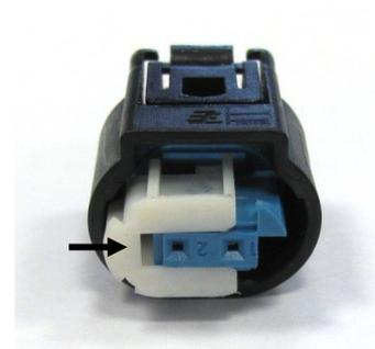
VA Elektronik Modul mit den mitgelieferten Kabelbindern am Kabelbaum befestigen und in die neue Buchse einstecken. Auf die korrekte Verriegelung des Steckers achten! Leitung mit Kabelbindern am Kabelbaum befestigen.
