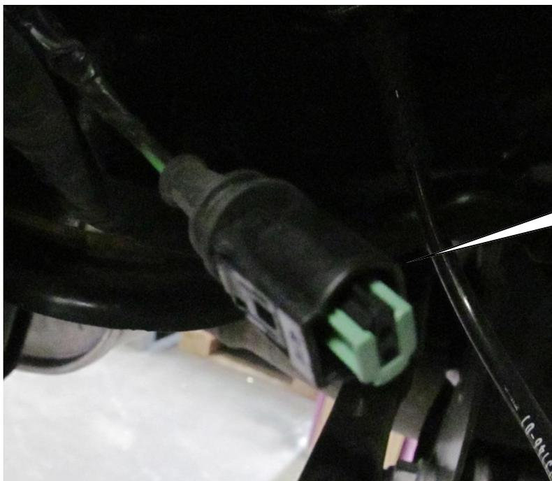
Original Leitung in die mitgelieferte Buchse mit Abdichtungen ganz einschieben und einrasten. Pinposition / Kabelfarbe ist nicht relevant. Anschließend Steckergehäuse verriegeln.
