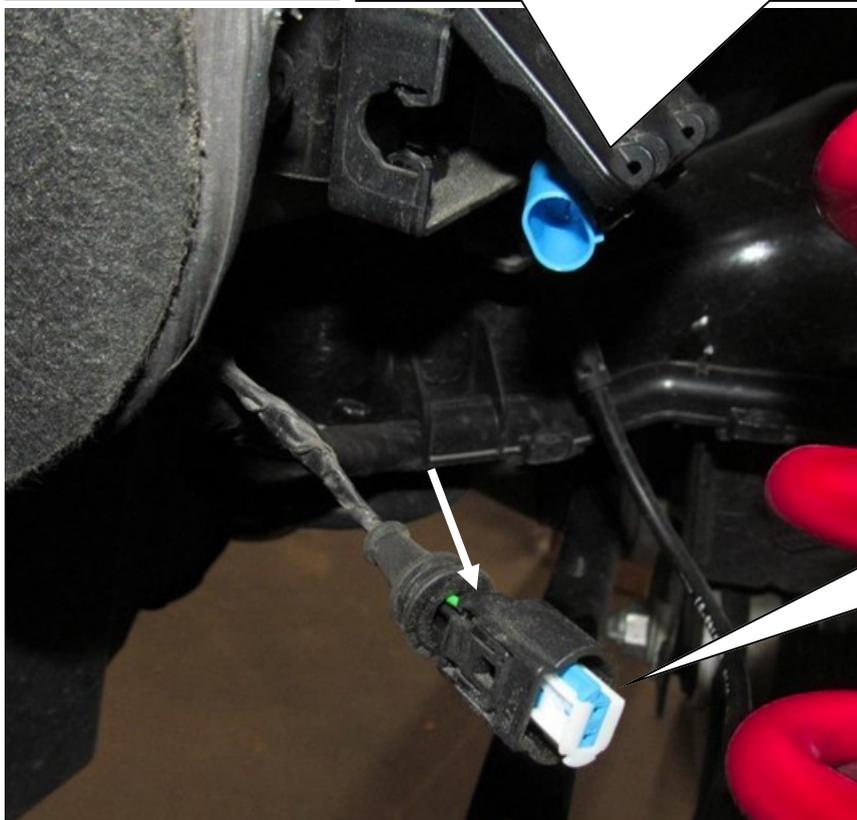
Anschließend das Gehäuse am Kabelbaum des Fahrzeugs mit einem geeignetem Werkzeug ausspinnen.
