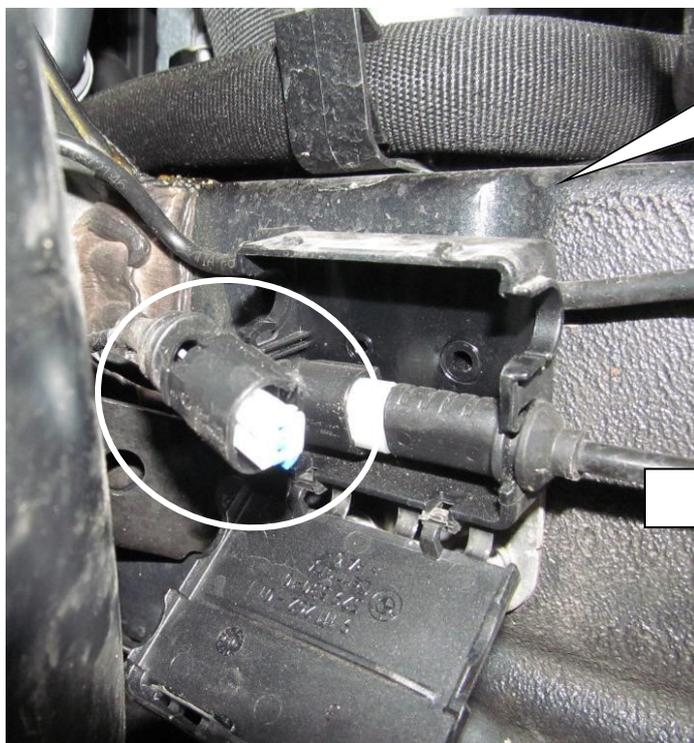
Anschließend das Gehäuse am Kabelbaum des Fahrzeugs mit einem geeignetem Werkzeug ausspinnen / demontieren.
