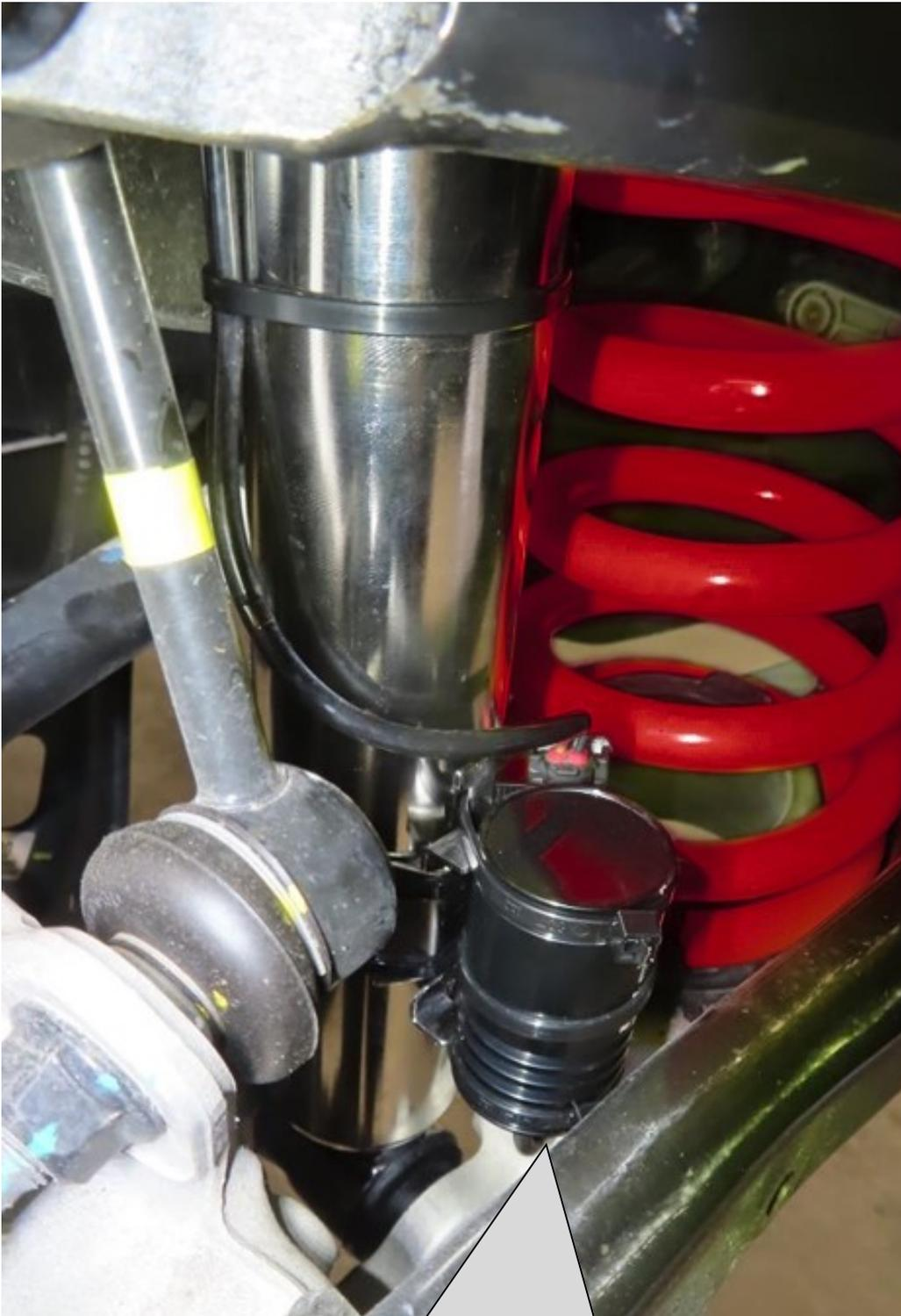
**Stilllegung muss in Richtung Fahrzeugheckseite zeigen.**
