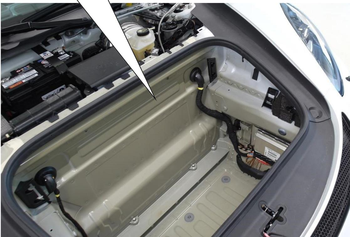
Stecker ausstecken und am Kabelbaum mit Kabelbindern befestigen.
