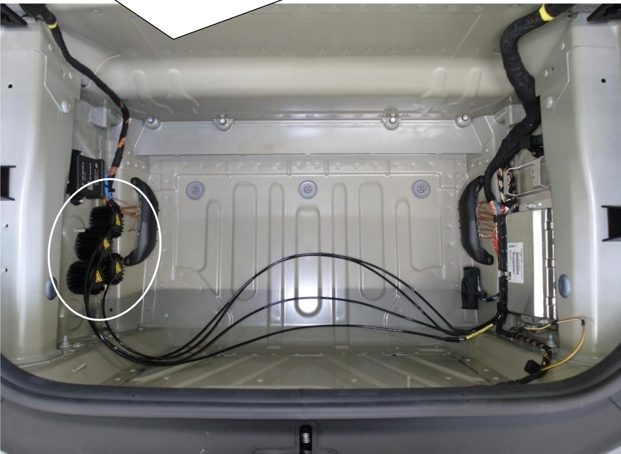
Leitungen mit den mitgelieferten Klebehalter und Kabelbindern befestigen.
