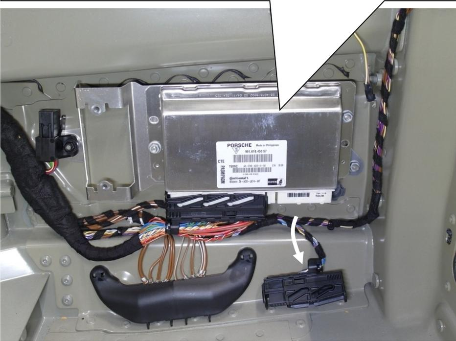
Mitgelieferter Stecker (Adapter) in das Steuergerät einstecken und verriegeln.
