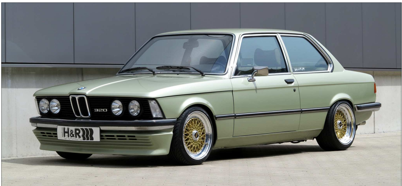
Prüffahrzeug mit H&R-Gewindefahrwerk 28777-1 / -2 bei max. geprüfter Tieferlegung
