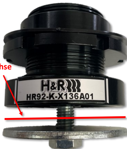
Abb. 4: Montage HA Höhenverstellung Fig. 4: assembly RA height adjustment
