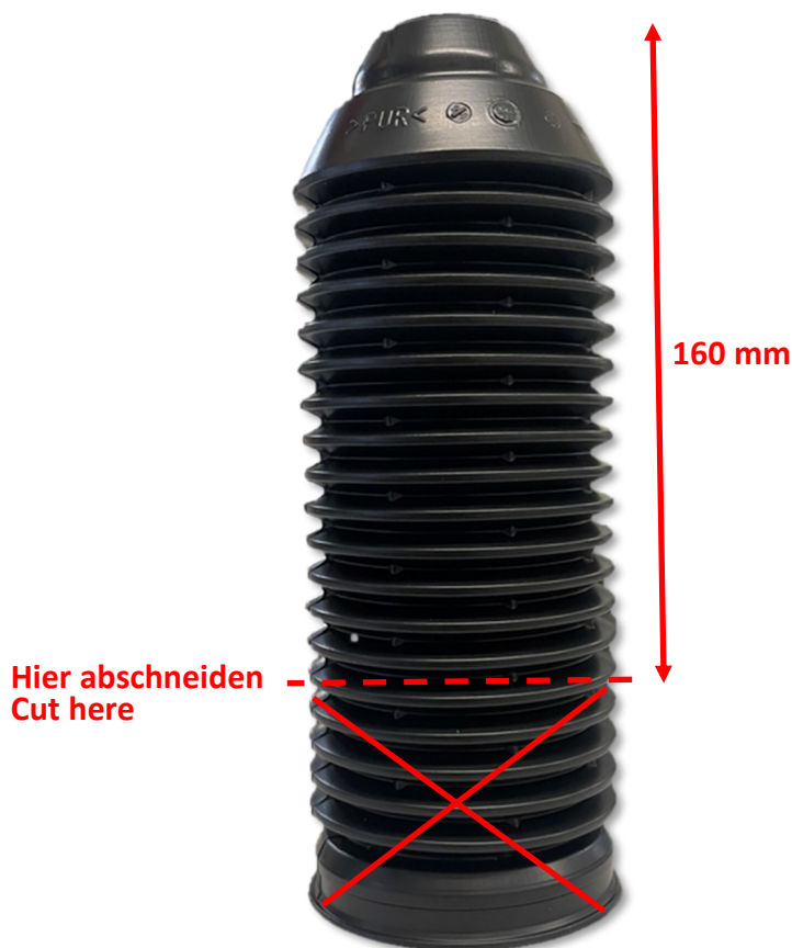
Abb. 1: Schutzrohr kürzen
