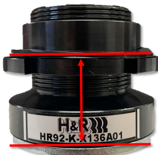
Abb. 5: Einstellmaß HA Fig. 5: RA adjustment dimension
