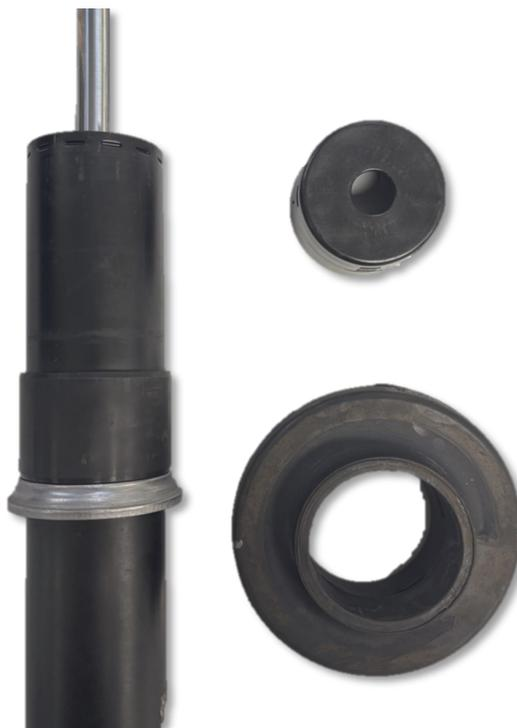
**Abb. 2:** Federteller demontiert
