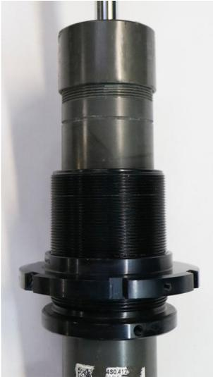
**Abb. 5:** Höhenverstellung u. Abdeckkappe montieren (Abbildung ähnlich)
