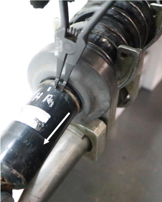
**Abb. 8:** Sicherungsring nach unten verschieben
