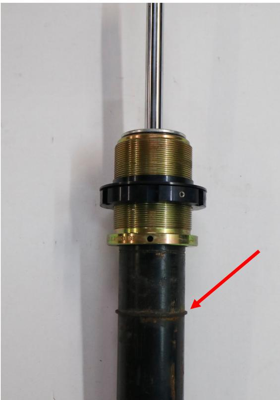
**Abb. 10:** Sicherungsring und Höhenverstellung mont.
