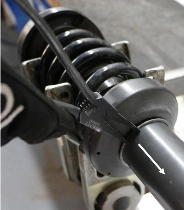
**Abb. 1:** Sicherungsring nach unten verschieben
