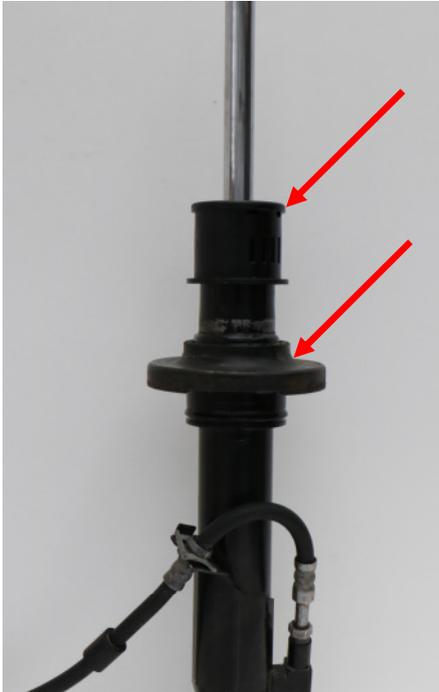
**Abb. 1:** Abdeckkappe und Federteller demontieren
