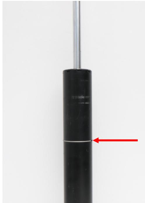
**Abb. 2:** Alle Teile bis auf den Sprengring entfernen
