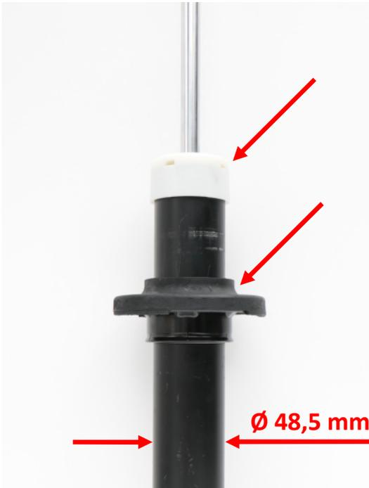
**Abb. 1:** Abdeckkappe und Federteller demontieren
