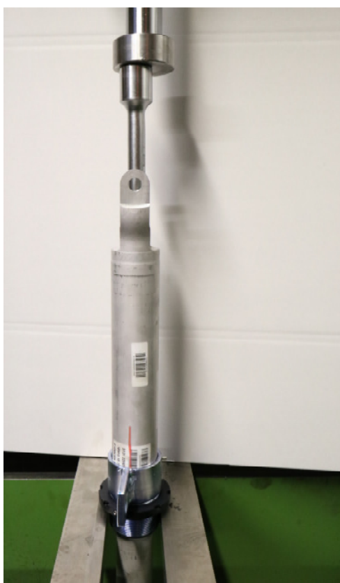
Abb. 3: Höhenverstellung aufpressen Fig. 3: Press the height adjuster on the damper
