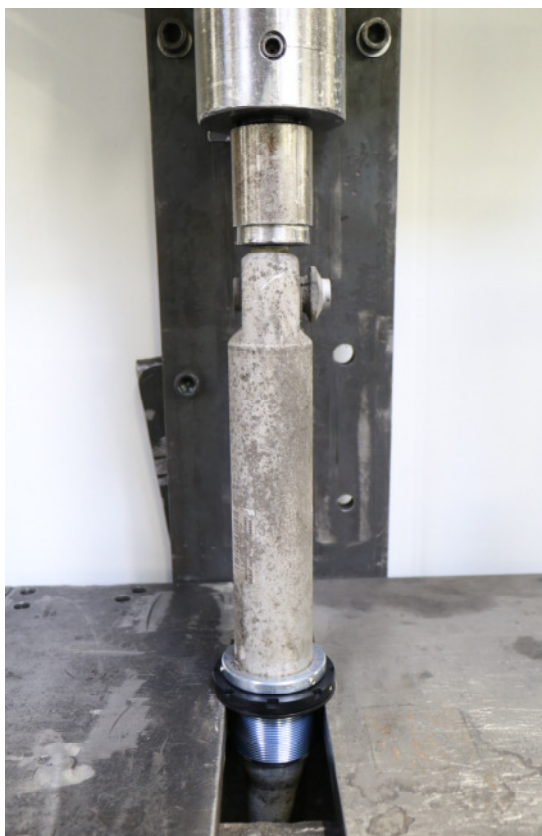
Abb. 9: Höhenverstellung aufpressen Fig. 9: Press the height adjuster on the damper
