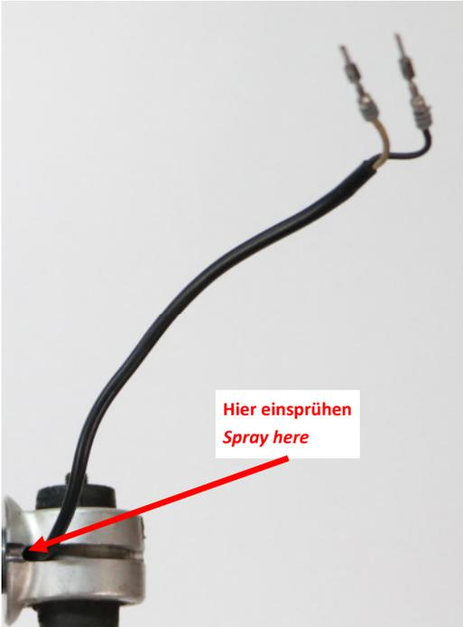
**Abb. 1:** Demontierter Stecker
