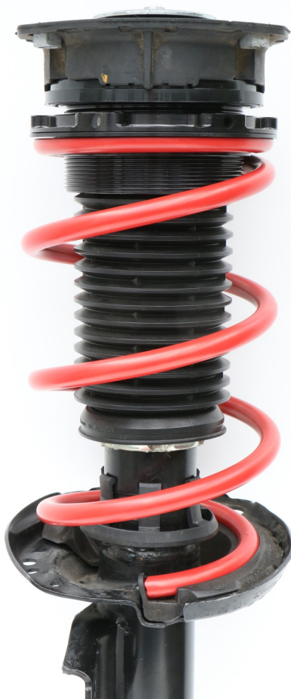
Abb. 6: Federbein komplett (Abbildung ähnlich)
