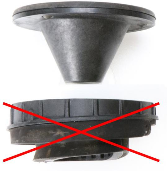
**Abb. 4:** Obere Federunterlage entfällt, Zentrierkegel wird wiederverwendet
