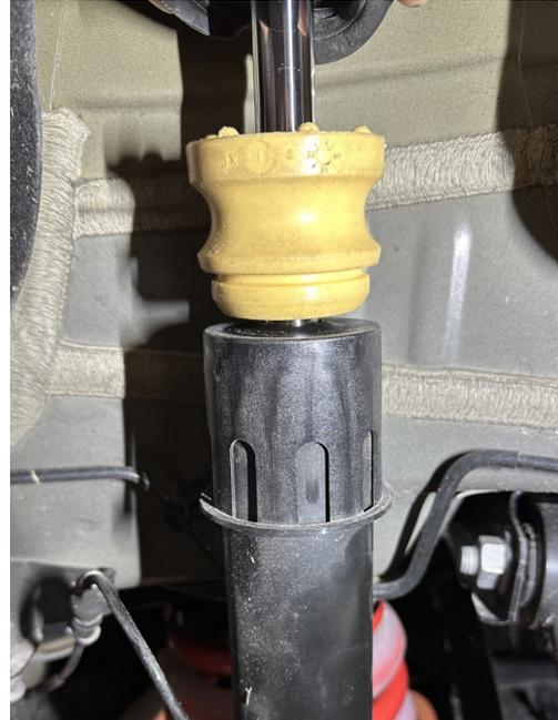
Abb. 6: Anschlagpuffer montieren
