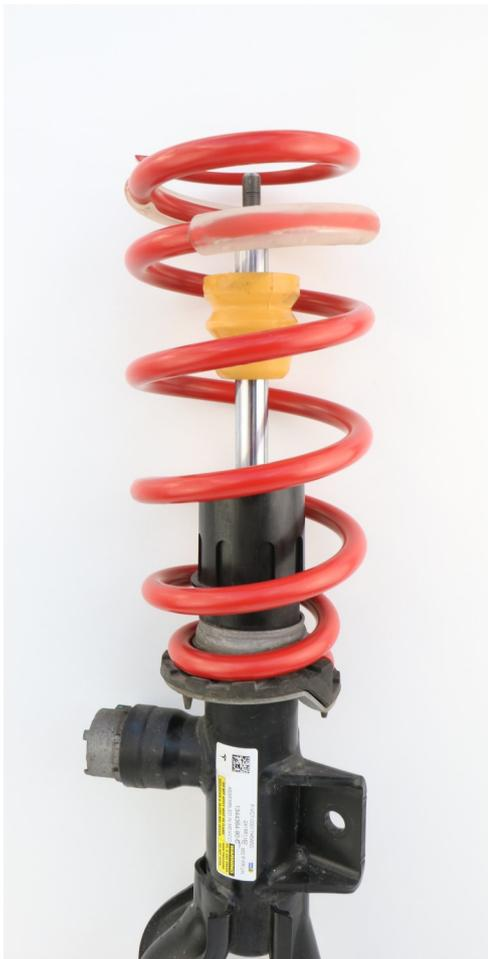
**Abb. 2:** Feder und Anschlagpuffer montieren
