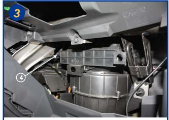
Ouvrir le boîtier filtrant par la gauche (4) et retirer la trappe.
