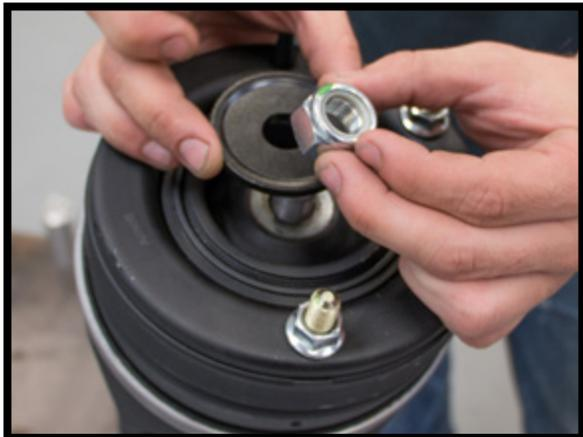
INSTALE LA ARANDELA NEGRA CON EL BORDE MIRANDO HACIA ARRIBA. A CONTINUACIÓN, INSTALE LA TUERCA Y APRIÉTELA.
