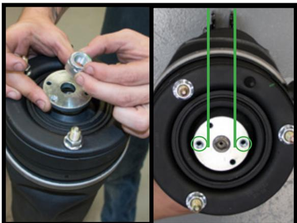
REUTILICE Y VUELVA A INSTALAR LA ARANDELA PLATEADA EXISTENTE Y ALINEE LOS ORIFICIOS ROSCADOS CON LA HORQUILLA INFERIOR DEL AMORTIGUADOR.
