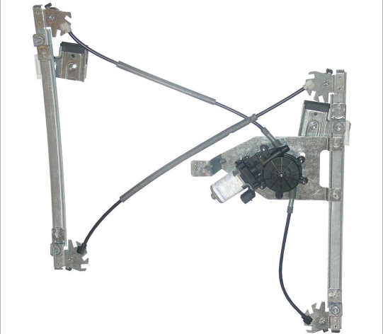
POWER WINDOW LEFT ALZACRISTALLI ELETTRICO SX
