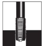
Nei filetti per candele non è necessario il preforo di allargamento ma si usa l'utensile combinato che fora e filetta. Fare attenzione che per maschi a macchina formatori sono necessari fori di diametro più grande.
