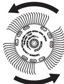
4. Fügen Sie die beiden Hälften des entsprechenden Adapters durch das Bürstenband bzw. den Radierer zusammen. Achten Sie darauf, dass diese korrekt zusammengefügt werden. Setzen Sie nun den Adapter auf die Spindel des Schleifers und befestigen diesen mit der zugehörigen Schraube. Der Adapter wird über den Innen-6kt. auf der Spindel justiert
