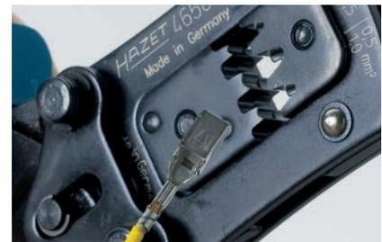
Zusammendrücken der Zangengriffe (löst Crimpvorgang aus) bis die Zwangssperre entriegelt.
