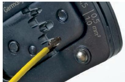
Kabellitze 5 mm abisolieren, von vorne einlegen und bis zum Isolationsstop schieben.
