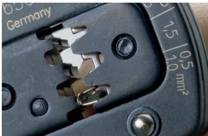
Kabelschuh von hinten so positionieren, dass der Isolationsstop in die erste Vertiefung des Kontakts greift und mittels leichter Zangenbetätigung fixieren.
