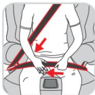
Теперь проведите бедренный ремень (W) с язычком замка (V) через подлокотники детского автокресла к замку трехточечного ремня безопасности и введите язычок замка (V) трехточечного ремня автомобиля в замок трехточечного ремня со слышимым характерным щелчком.
