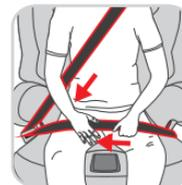
Zavedte diagonálny pás do červene označeného vedenia (E) pásu na boku opierky hlavy (D) a napnite ho v smere k navíjacímu mechanizmu. Diagonálny pás musí byť napnutý a nesmie byť prekrútený.
