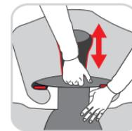
Relâchez le levier et laissez enclencher l'appuie-tête de manière audible. Testez si on ne peut plus la déplacer l'appuie-tête. L'appuie-tête doit entourer la tête sur toute la hauteur.
