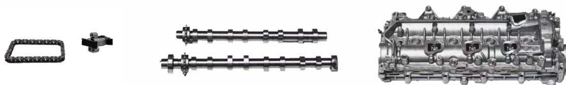
Recomenda-se também que se evite a utilização excessiva de massa de vedação, uma vez que pode obstruir os orifícios de passagem de óleo, levando a uma má lubrificação e ao risco de quebra do tensor e/ou da corrente.
