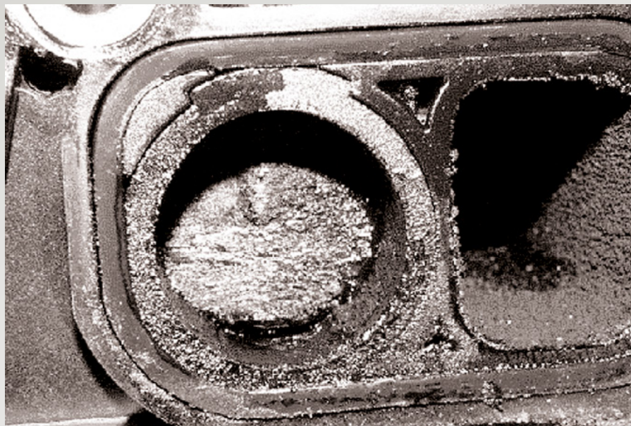
Abb. 44 Tumbleklappen, ausgefallen wegen starker Ablagerungen
