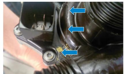
Problème possible avec la pompe de série : rupture du boîtier en matière plastique.
