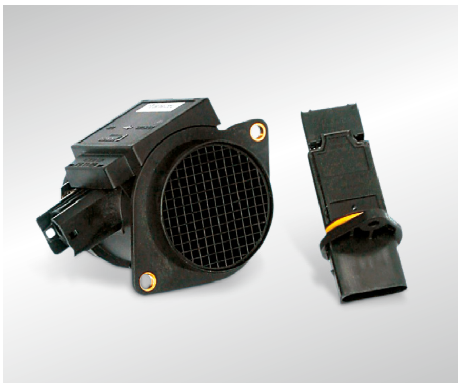
Fig. 40 Différents types de débitmètre d'air massique
