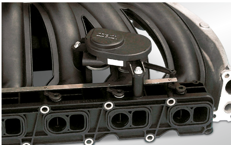
Fig. 41 Collecteur d'aspiration avec clapets « Tumble » et EAM-i
