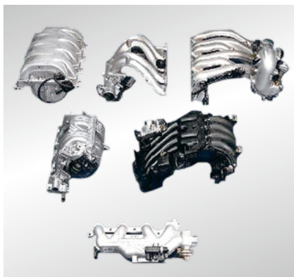
Fig. 43 Différents types de conduites d'aspiration
