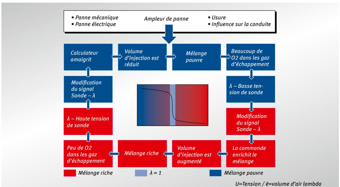
Fig. 46 Circuit de régulation avec sonde lambda.
