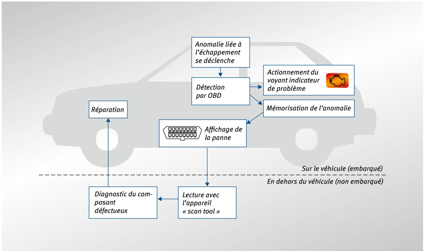
Fig. 5 Principe de fonctionnement du diagnostic embarqué
