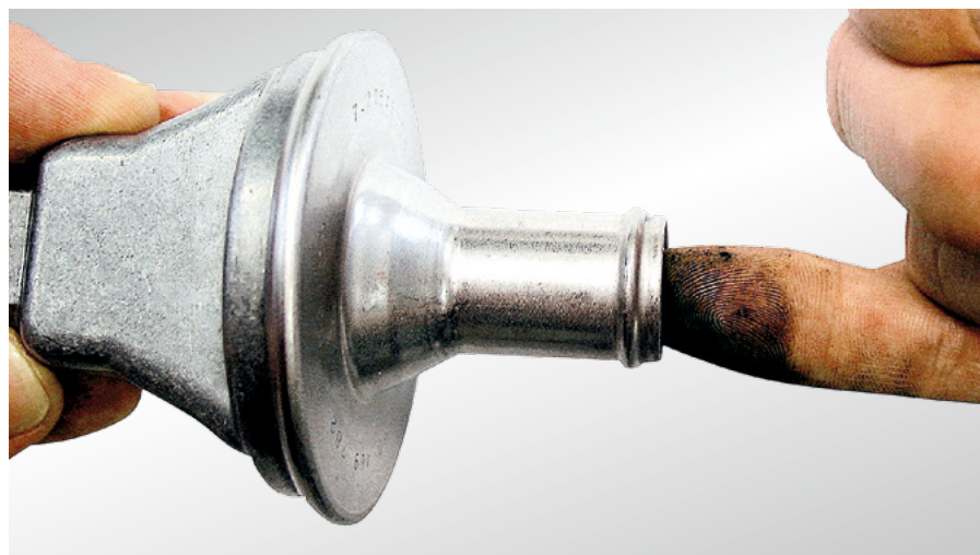
Рис. 32 Простая проверка обратного клапана
